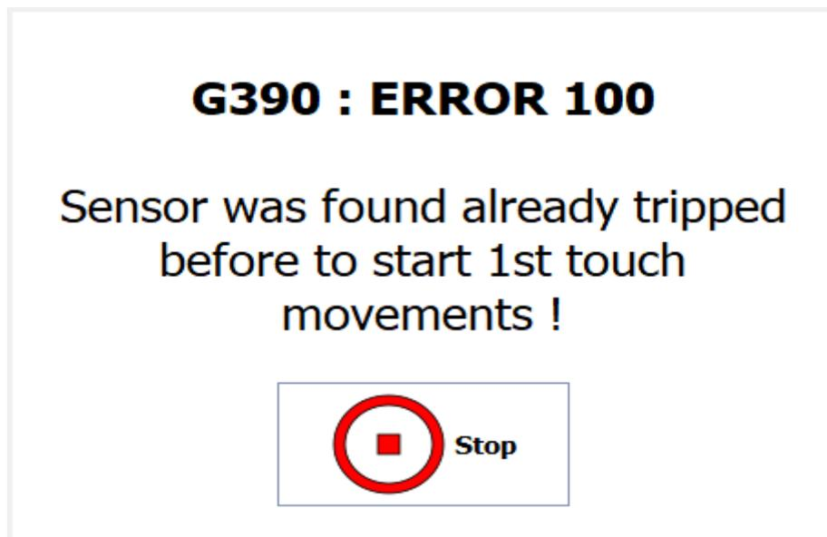
Alla comparsa dell'errore i movimenti verranno interrotti e alla pressione del pulsante STOP l'esecuzione del codice NC interrotta.
